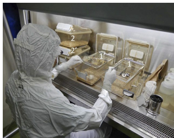
Fig. 8. 安全キャビネット内におけるケージ交換手順 安全キャビネットでは, 2つの使用中のケージ (1', 2') と2つの交換用のケージ (1, 2) を設置した。マウスの移動はFig. 6 (b) の手順に従った。この方法は評価3で用いた。
