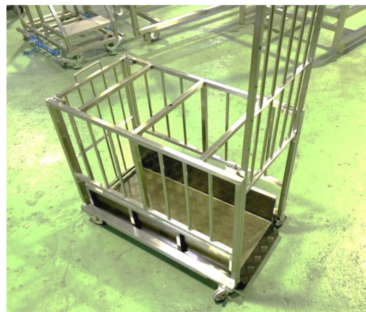
試作中の低床型ブタ体重測定台車
