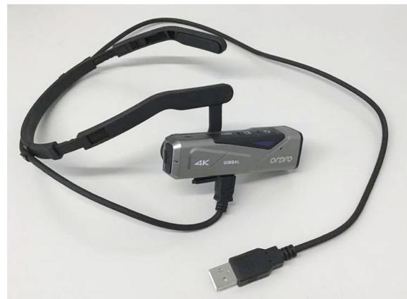
図1 撮影に使用したウェアラブルカメラ「Ordoro EP7」、頭部に装着するとカメラのレンズが右目に並ぶ格好になる。
