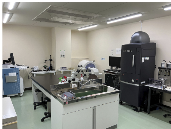
写真5 小動物用イメージング室（超音波エコー、X線CT、蛍光・発光イメージング装置などが設置されている。イヌの実験室を改修した）
