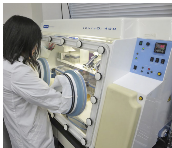
図1 嫌気チャンバー チャンバー内は嫌気条件、37℃に保たれています。
